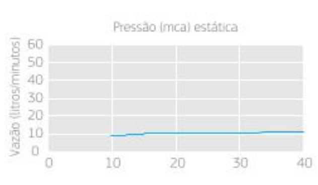
Figura 23: Curva de vazão das duchas. Fonte: Deca
